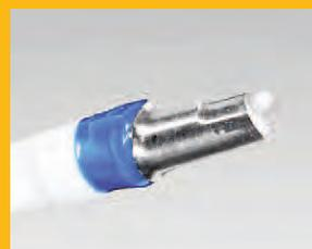
Das Pattern Resin® zweimal deckend mit Silberleitlack bestreichen. Den Übergang zwischen Implantatabutment und optiCLIC-Kontaktierungsstab mit Galvanowachs bedecken.
