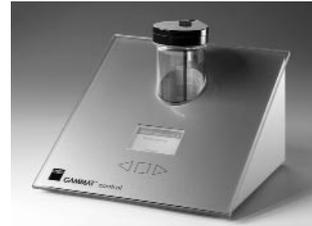
mit dem **GAMMAT® control** innerhalb von 5 Minuten exakt die Goldmenge der zu galvanisierenden Teile ermittelt und Ihnen dies auf einem Display anzeigt. Sie setzen die zu galvanisieren-
